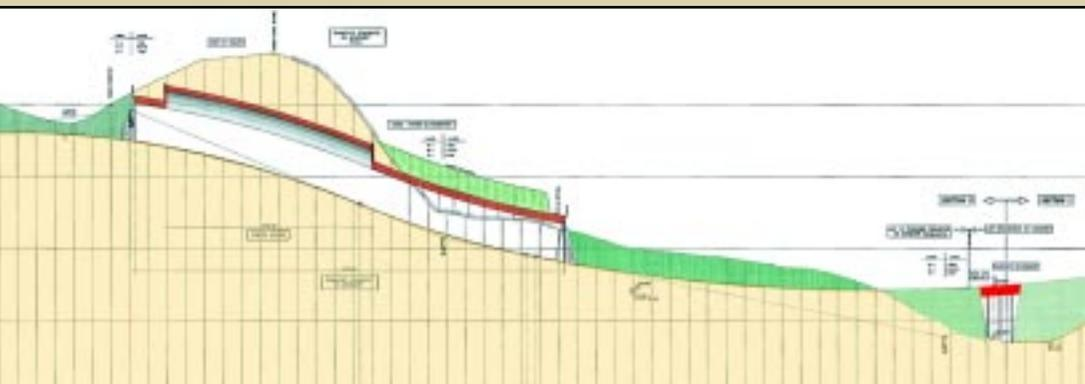
différents au niveau de la dalle de couverture à savoir, une section dite «voûtée» et une section dite «en cadre».
