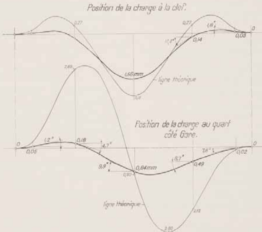
Fig. 29. — Lignes de fléchissements verticaux mesurés et calculés. Positions de la charge «A» à la clef et au quart côté Gare.
