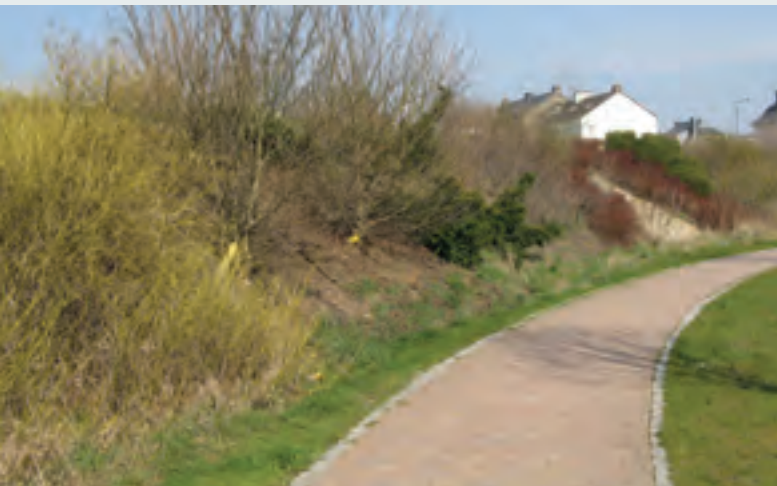
Exemple négatif: Chemin pédestre longeant un rond-point. Critiques : végétation arbustive constituée d'essences non indigènes, dalles du chemin posées dans le béton, d'origine étrangère et d'une couleur non adaptée au paysage, bordure entre le chemin et les surfaces végétalisées, épandage d'herbicides, fauchage intensif.
