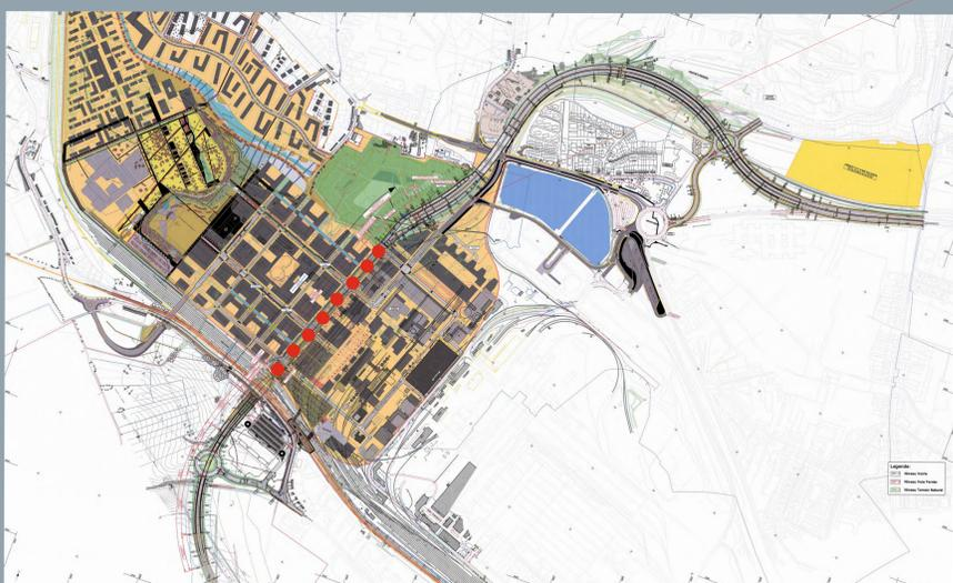
Le tunnel, d'une longueur de 735m, représente le plus gros ouvrage de génie civil du projet de liaison entre Esch-sur-Alzette (L) et Micheville (F). Le «Central Gate» est l'artère principale du site. Orienté globalement selon un axe Sud-Nord, il présente en plan un tracé formé par un tronçon droit de 600 mètres côté Micheville et un virage d'un rayon de 300m sur les 135 derniers mètres côté Esch-sur-Alzette.
