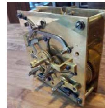
Vorderansicht des Werkes mit dem Zeigerwerk, den Hebeln für den Schlag und den beiden Wellen zum aufziehen der Federn
