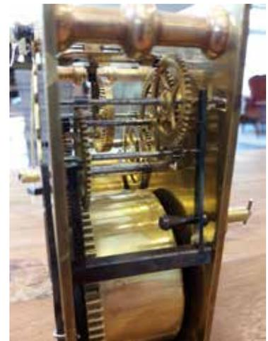
^ Innenansicht des Räderwerkes mit den Federhäusern und der Spindelhemmung
