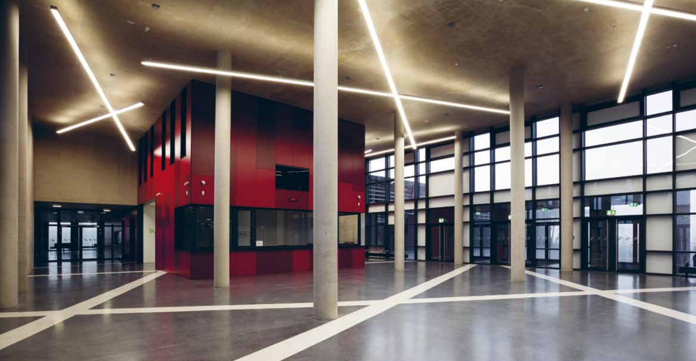
D'autre part les dalles en béton armé restent apparentes afin de pouvoir profiter de cette masse à grande inertie thermique qui agit comme régulateur de la température et de l'humidité au profit du confort intérieur. En hiver, ce principe permet de réduire les besoins en chauffage tandis qu'en été la masse du bâtiment assure la fonction d'accumulateur qui est refroidi pendant la nuit pour éviter ainsi le surchauffement du bâtiment.
