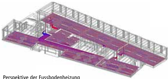
_Perspektive der Fussbodenheizung
