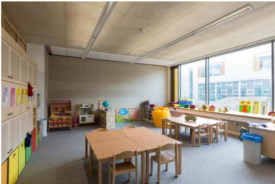
Le reste du plafond a été laissé en béton vu afin de garder assez de masse thermique servant à l'établissement d'un bon climat intérieur des bâtiments. En effet, le nouveau Centre de Logopédie est basé sur les principes du « concept confort » qui se résume par les trois règles suivantes :
